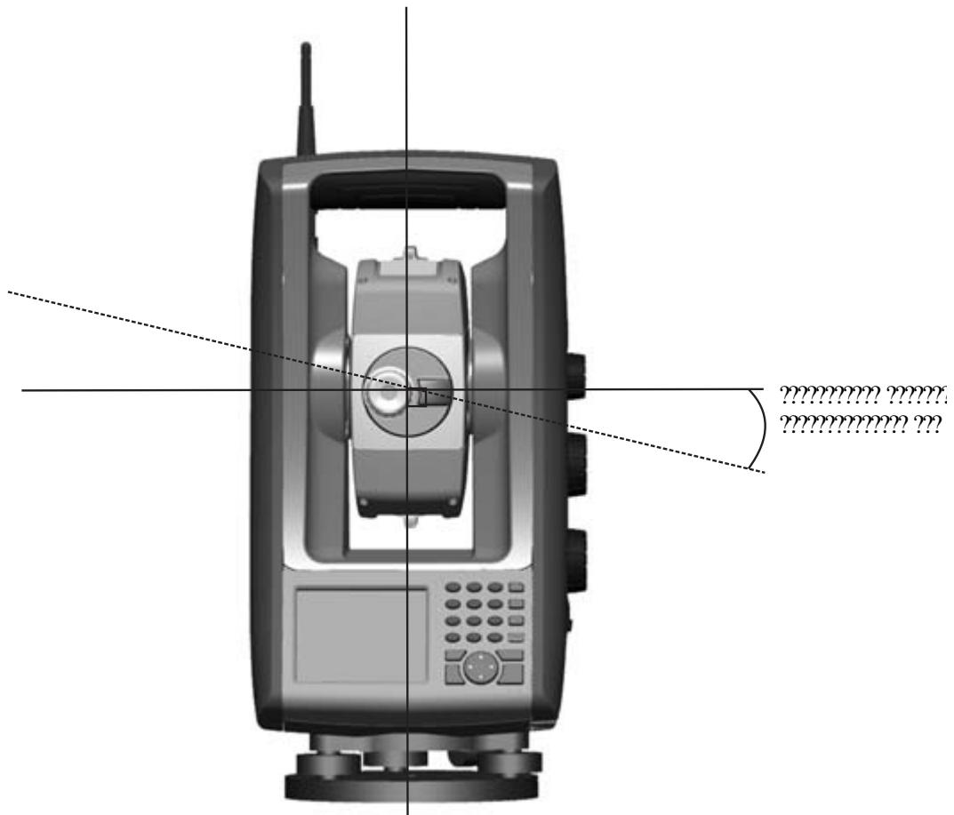
В тахеометре Spectra Precision FOCUS 35 перед измерением выполните поверку наклона горизонтальной оси вращения для определения ошибки наклона горизонтальной оси вращения. Угловые измерения выполняются при двух кругах инструмента, вычисляется ошибка наклона горизонтальной оси вращения, а в памяти инструмента сохраняются соответствующие значения поправок. Значение поправки на наклон горизонтальной оси вращения затем применяется как поправка к значению горизонтального угла.
