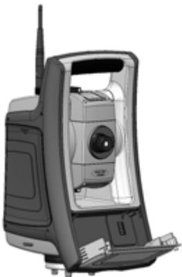
2. Вставьте батарею в батарейный отсек контактами вверх.
